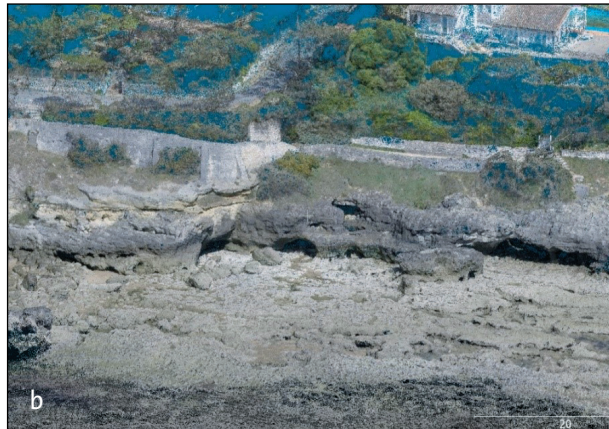
Figure 5. a - Topographie de la cavité des Corsaires (source : Cerema, CDS 16, Creocéan, DDTM 17) ; b - Vue 3D de la falaise établie à partir d'un nuage de points photogrammétrique acquis par drone (source : Cerema, Creocéan, DDTM 17).
